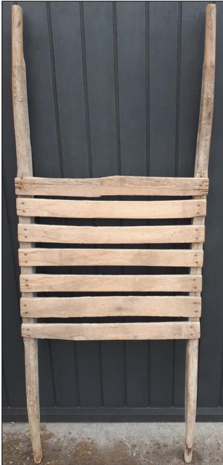
Berrie voor het lossen van stenen uit een schip afkomstig van de vroegere Firma Van Maldeghem langs het Schipdonkkanaal (nu DSM-keukens).
